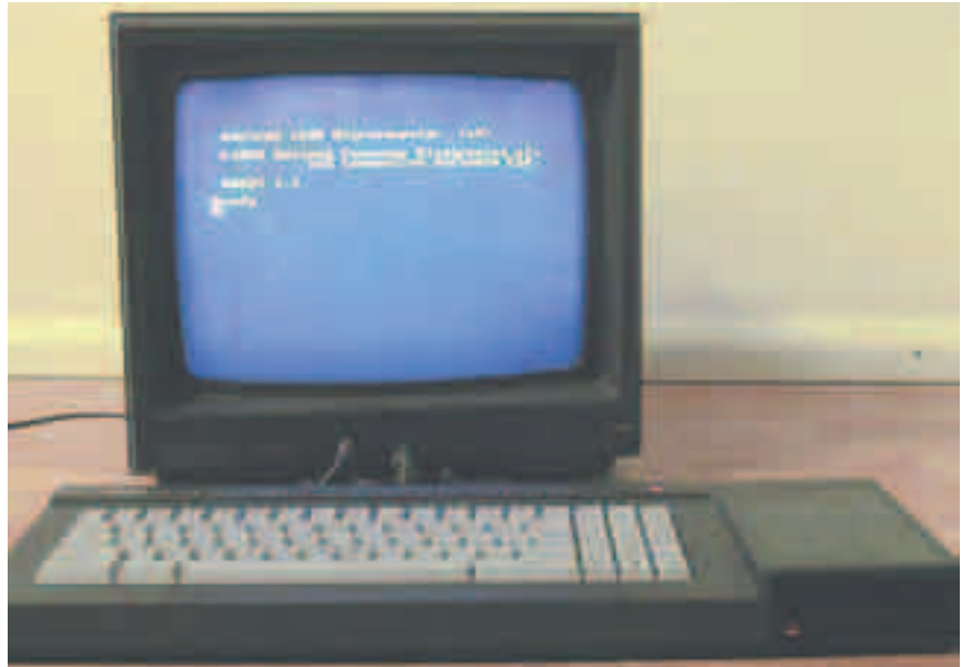
CPC 6128, con 128Kbytes de RAM y unidad de disco de 3".
