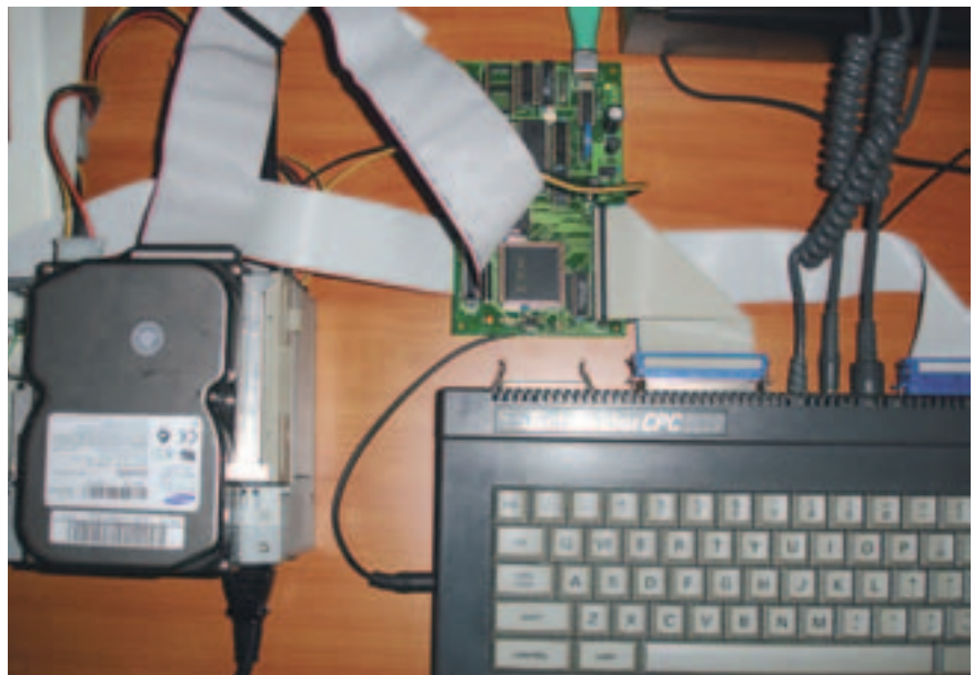
Symiface II conectado a un CPC 6128, y disco duro alimentado externamente.
