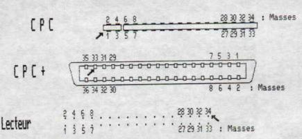
La flèche indique la position du Ready. Vous constaterez que pour une liaison avec un CPC, les connecteurs encartables se retrouvent orientés d'un même coté de la nappe, alors qu'avec un CPC+ ils sont de part et d'autre.
